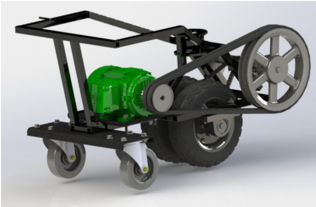
Figura 4.8: Vista do Vecarr modelado em SolidWorks.
