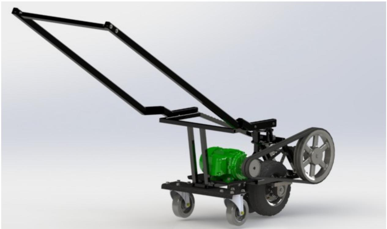
Figura 4.9: Vista do Vecarr modelado em SolidWorks.
