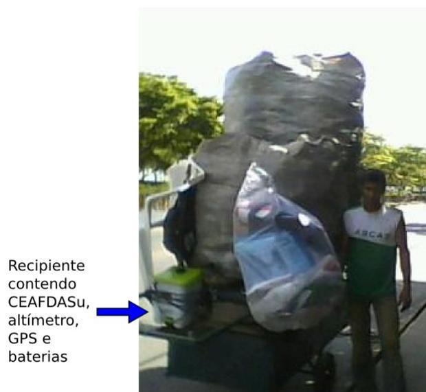
Figura 3.3: Fotografia dos componentes eletrônicos embarcados para registro dos sinais de força e trajetória dos catadores.
