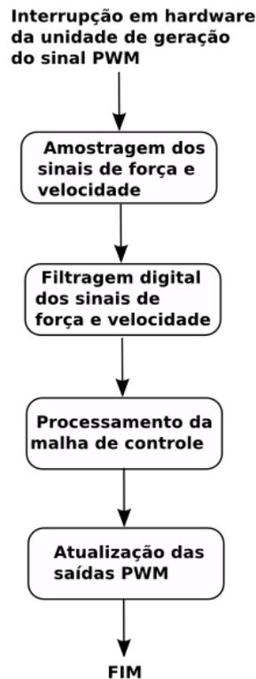
Figura 5.2: Fluxograma do *software* de controle implementado na plataforma DSP. A sequência de eventos é executada a cada interrupção de *hardware* gerada pela unidade de geração de PWM.
