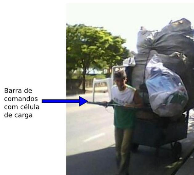
Figura 3.5: Fotografia da barra de comandos e célula de carga embarcados ao veículo dos catadores de papel.
