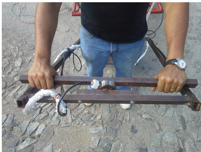
Figura 3.1: Arranjo de montagem da célula de carga ao veículo durante o monitoramento da rotina de catadores de papel.
