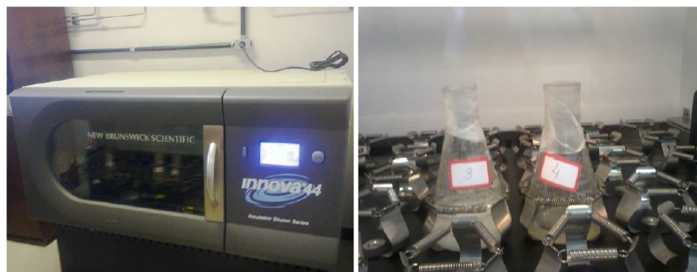
Figura 6.1 – Sistema de agitação de frascos com controle de agitação e temperatura (INNOVA 44)
