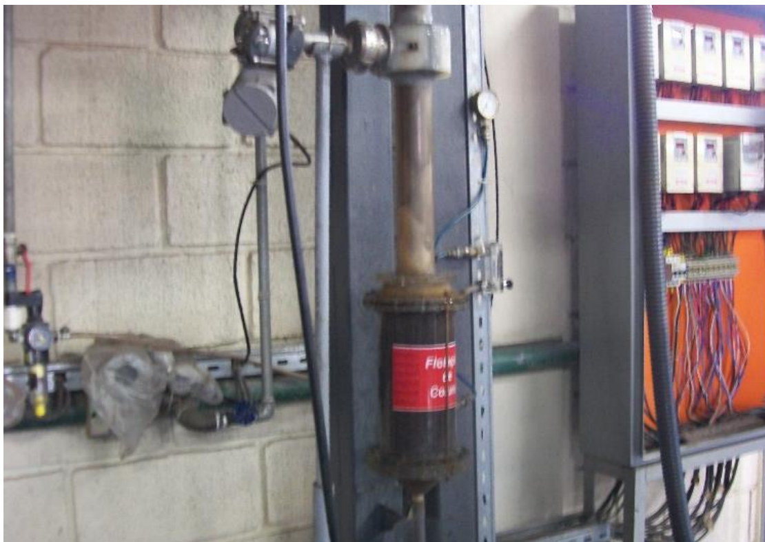
Figura 3.16: Coluna de flotação em teste de laboratório para minério de ferro (Arquivo pessoal, 2009)
