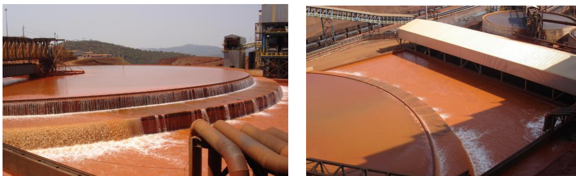
Figura 3.21: Overflow do Espessador de Lamas, Mina de Brucutu (Arquivo Pessoal, 2011)
