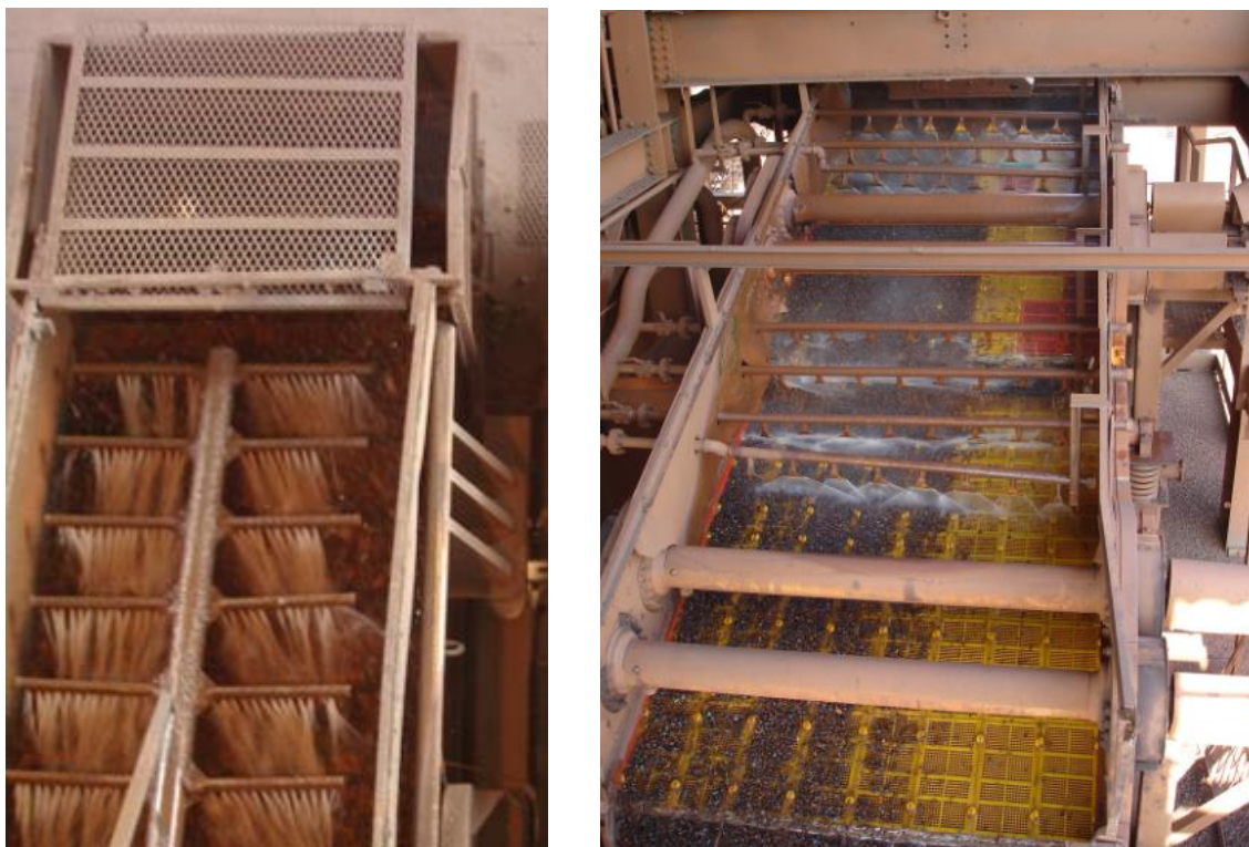
Figura 3.4: Sprays de água nas peneiras vibratórias (Arquivo Pessoal, 2011)
