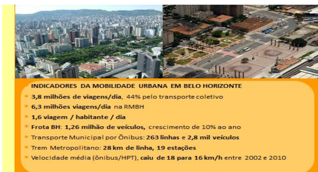
FIGURA 25: Indicadores de Mobilidade Urbana em Belo Horizonte FONTE: Belo Horizonte. Corredores de BRT em implementação (2009, p.2).
