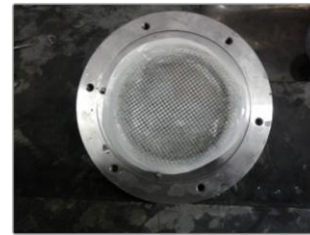
Figura 5 - Módulo de aço inox utilizado nos ensaios de nanofiltração e osmose inversa: (a) Diagrama esquemático da célula e (b) Parte interna do módulo
