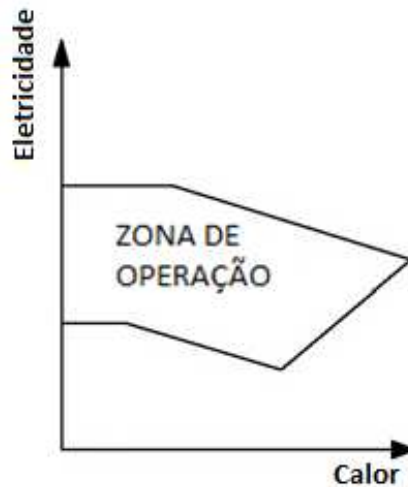
Figura 3.3 Curva não convexa Calor-Eletricidade - zona de operação viável para turbinas a Gás
