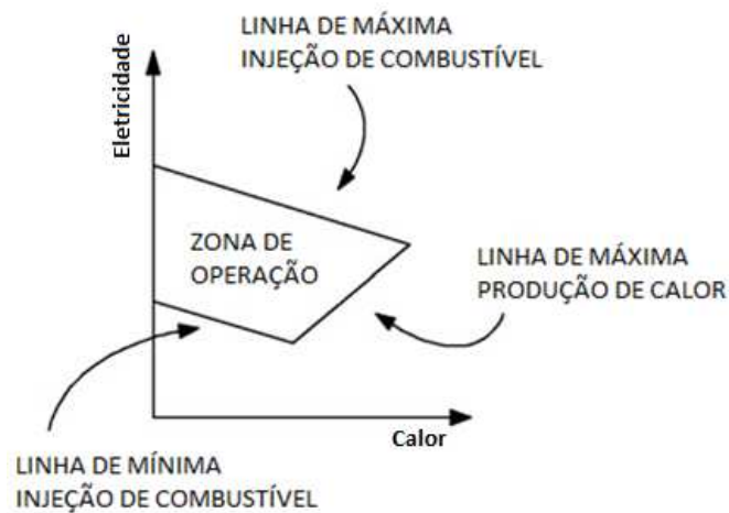
Figura 3.2 Curva típica Calor-Eletricidade - zona de operação viável
