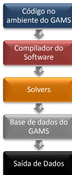
Figura 6.1 Fluxograma de funcionamento do GAMS (Adaptado de GAMS - A User's Guide, 2013)
