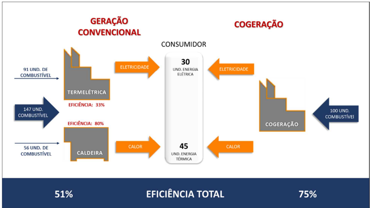
Figura 2.1 Eficiência total em um sistema convencional e em um sistema com cogeração de energia. (Adaptado de ETA, 2014).
