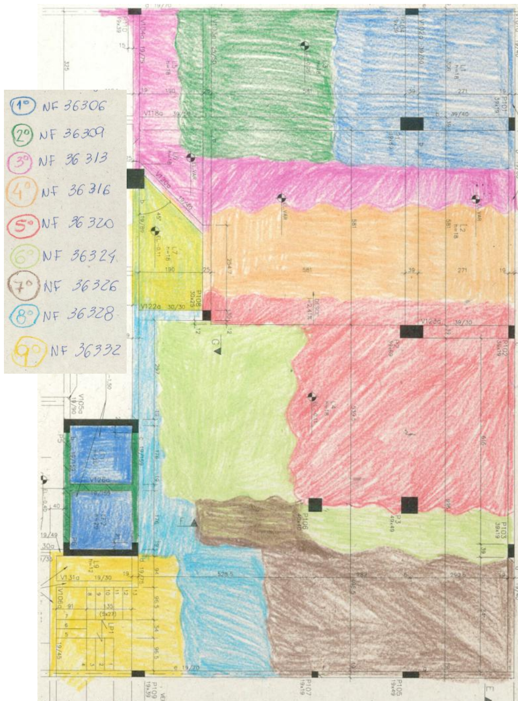
Figura 3. 4 - Rastreamento do concreto - 1ª Laje (Parte 1)
