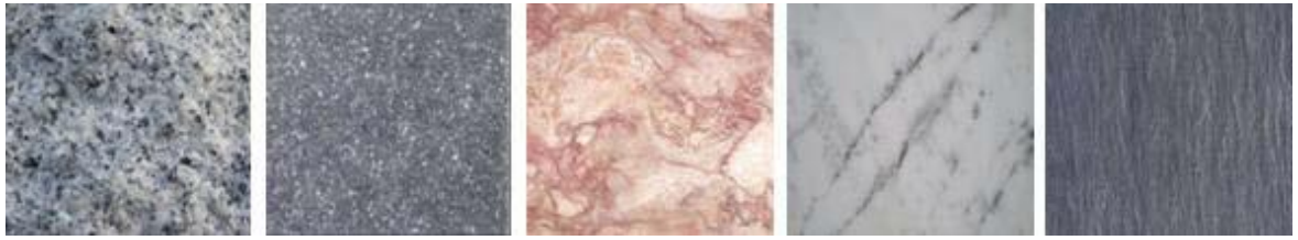
Figura 30 - Diferentes tipos de pedra: granito, basalto, calcário, mármore e ardósia.
