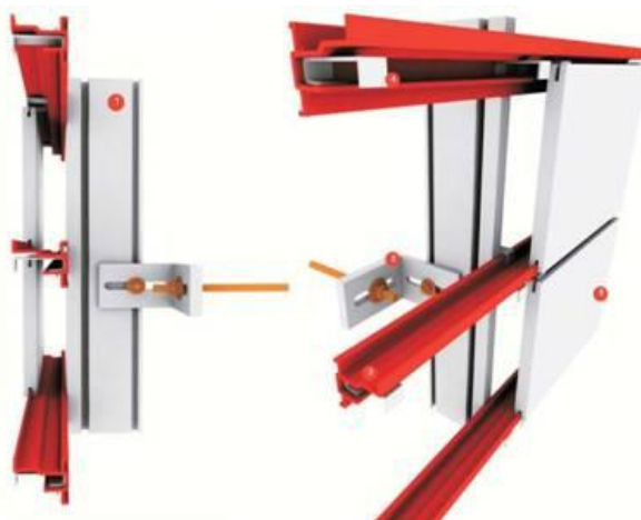
Figura 5 - Fixação para revestimentos de grande espessura.
