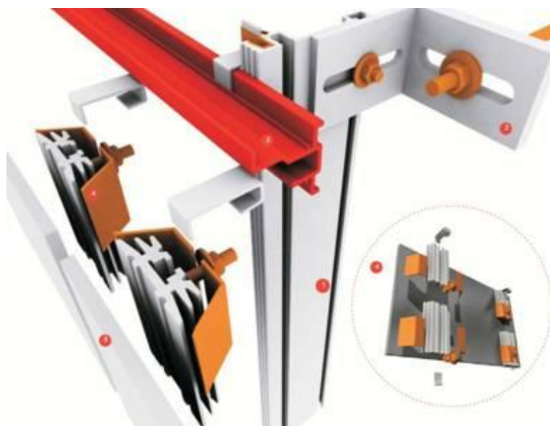
Figura 9 - Sistema de fixação oculta.
