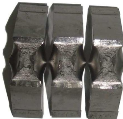
Figura 39: Aspecto da superfície de fratura dúctil após o ensaio de impacto Charpy, realizado à -130°C
