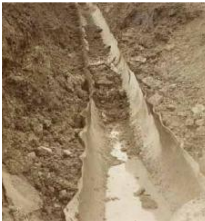
Figura 2: Aspecto da fratura dúctil, obtida no teste de Athens [7] .
