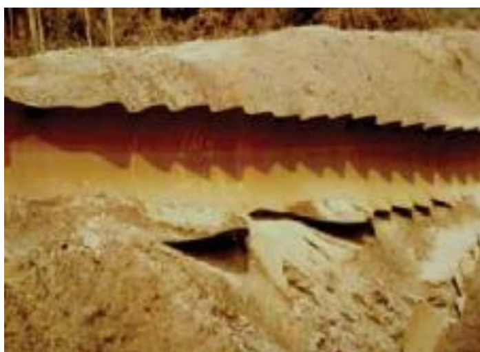
Figura 1: Aspecto da fratura frágil, obtida no teste de Athens [7] .
