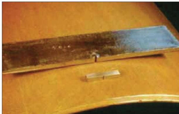
Figura 6: Corpos de prova DWTT e impacto Charpy entalhe em V [7] .
