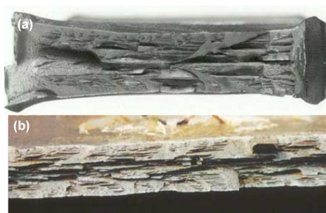
Figura 4: Superfícies de fratura de um tubo de aço API X100, de 36" x 16 mm, ensaiado a -50°C, obtidas a partir dos ensaios de (a) DWTT e (b) West Jefferson [22] .
