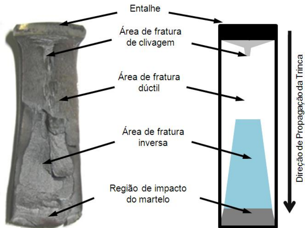
Figura 15: Superfície de fratura obtida em ensaio DWTT, com a identificação esquemática dos aspectos característicos de fratura inversa (adaptado) [41] .
