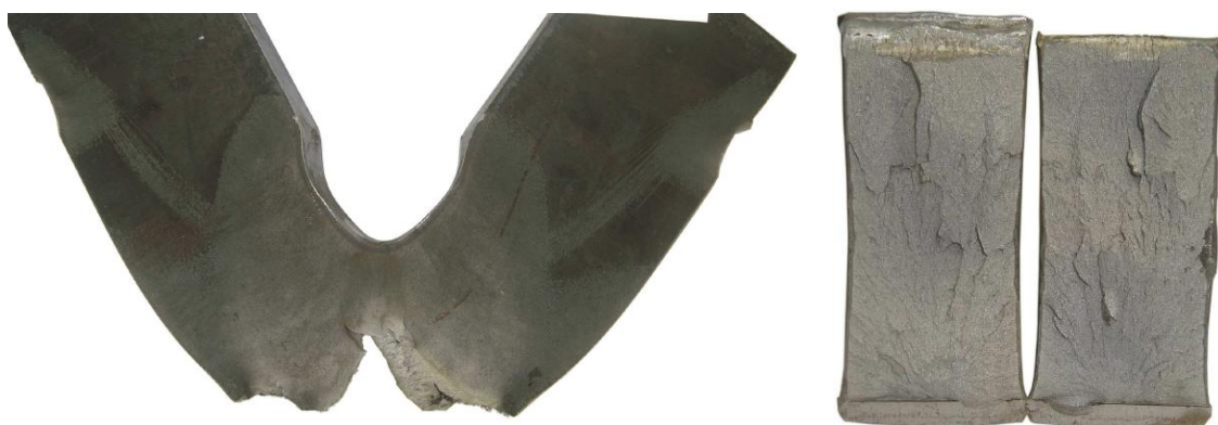
Figura 44: Variação do modo de fratura entre os dois corpos de prova, testados na mesma condição.
