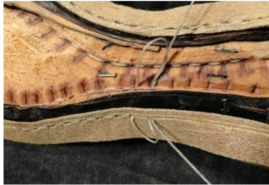
Figura 4 — Aplicação da vira: manual e mecanizada
