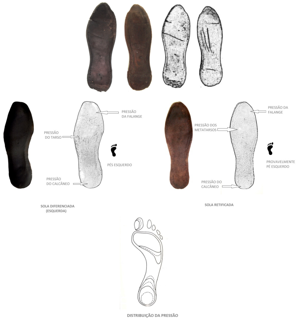
Figura 36 — Cortes, rachaduras e desgastes das solas
