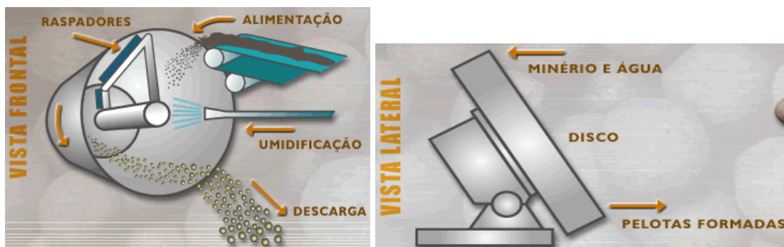
Figura 4 - Processo de pelotização
