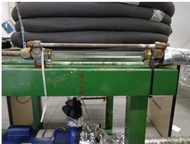
FIGURA 3.6 Visor do fluido R-407C.
