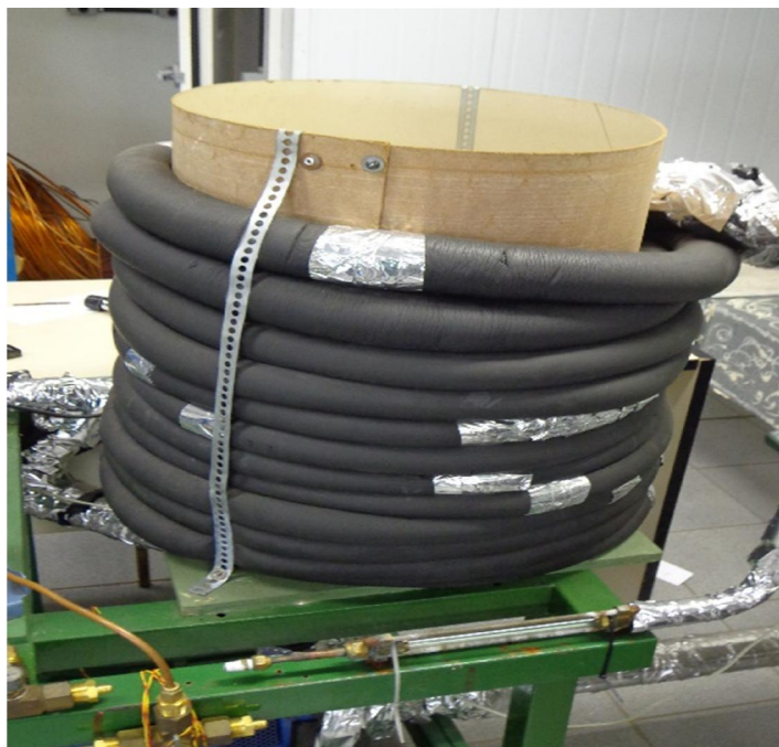
FIGURA 3.8 Condensador do circuito principal.
