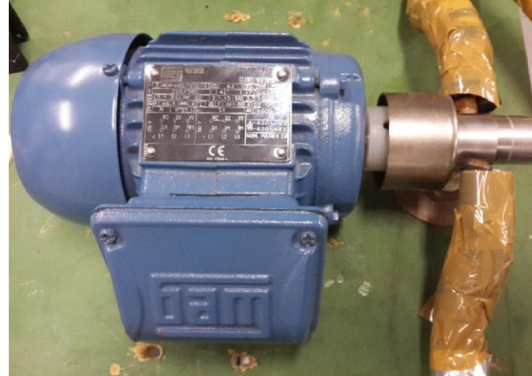
FIGURA 3.4 Bomba de Engrenagens utilizada na bancada de teste
