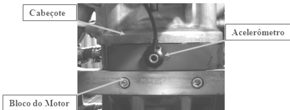
FIGURA 3.8 – Posicionamento do acelerômetro no bloco do motor
