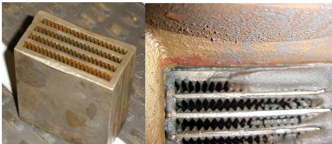
Figura 3.17: Matriz e matriz obstruída por magnetita. Arquivo Pessoal
