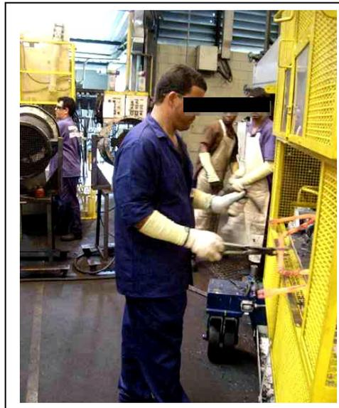
Figura 5 - Encaixe da barra na dobradeira.
