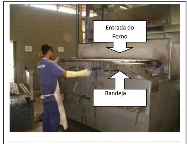
Figura 2- Postura e Gestos realizados pelo operador, para ajustar manualmente, a matéria prima depositada pelo eletroimã na bandeja de entrada no forno.
