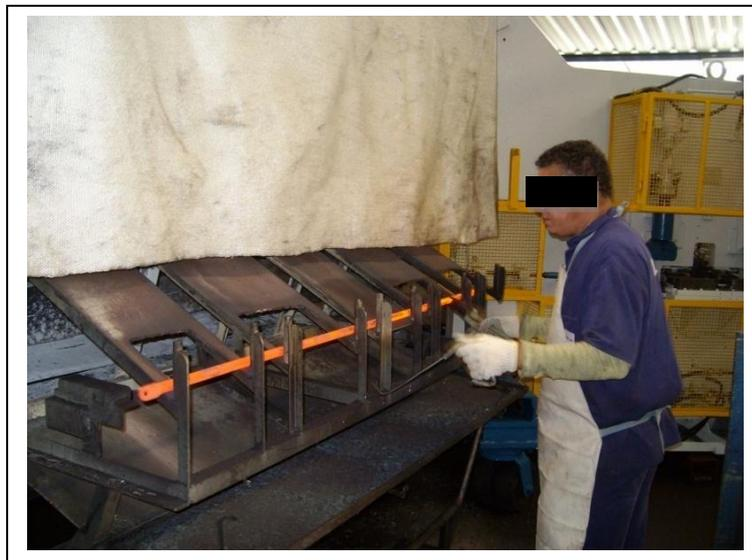
Figura 4 - Saída da barra incandescente do forno
