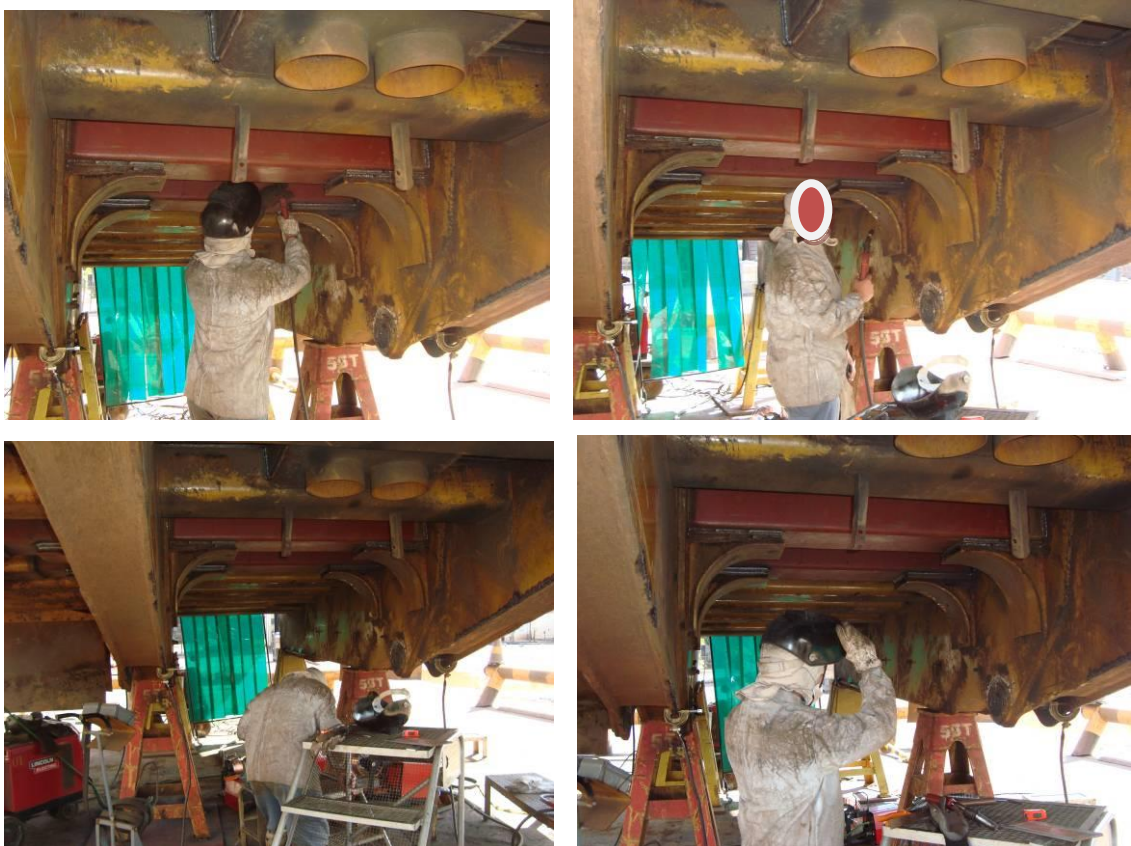
Figura 7 – Soldador no processo de goivagem na parte superior de uma caçamba de escavadeira.
