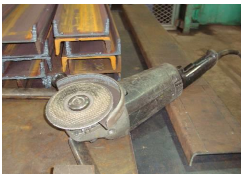
Figura 6 – Esmerilhadeira utilizada no processo de acabamento da solda.
