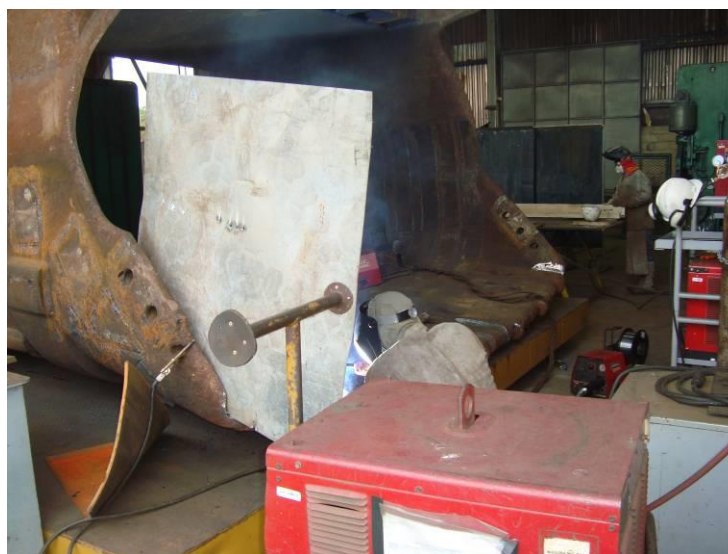
Figura 14 – Compensado utilizado pelo soldador em processo de soldagem para proteger a solda da corrente de vento.
