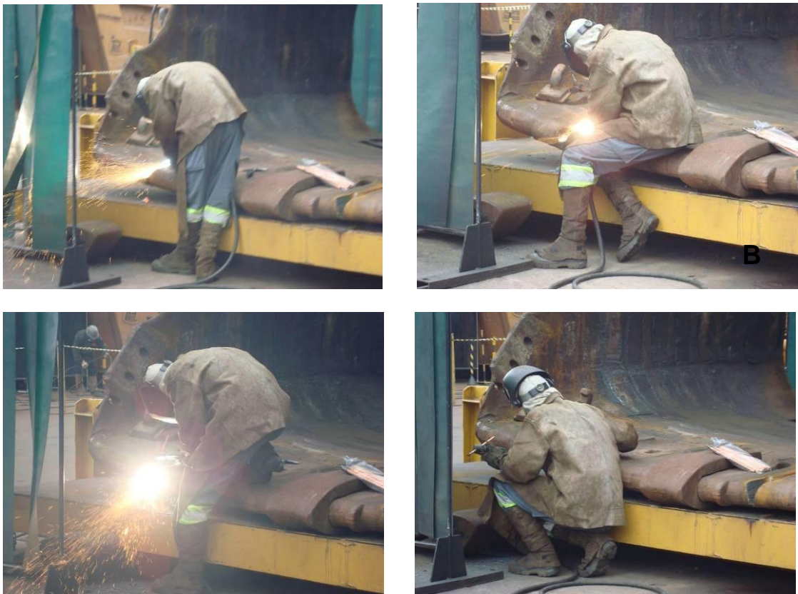
Figura 8 – Soldador realizando processo de goivagem na parte inferior do implemento.
