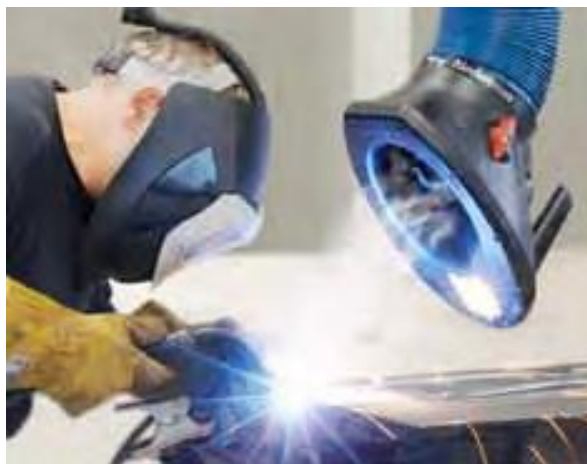
Figura 17 – Ilustração do sistema de exaustão utilizado em processos de soldagem.
