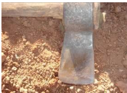
FIGURA 5: "MACHADINHA" COM FIO DE CORTE EM MAU ESTADO DE CONSERVAÇÃO
