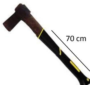
FIGURA 15: MACHADO COM CABO EMBORRACHADO ANTIDERRAPANTE
