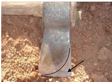
FIGURA 16: DETALHE DA ÁREA DA LÂMINA DO MACHADO A SER AFIADA EM MANUTENÇÕES PERIÓDICAS
