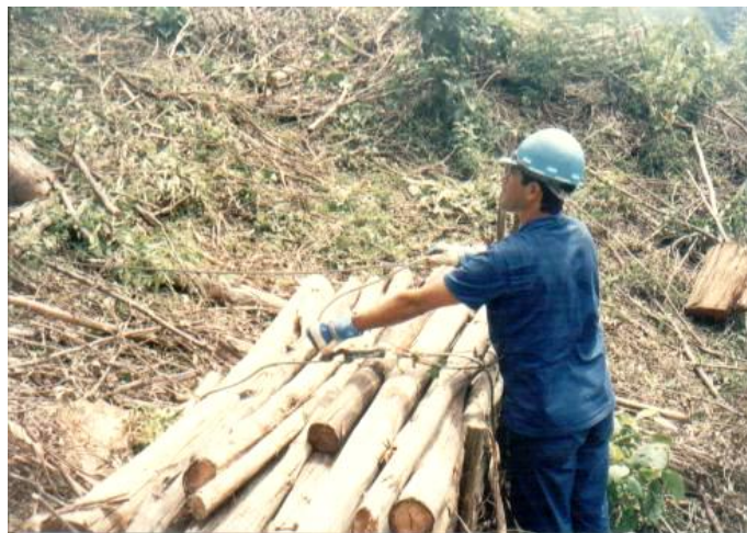
FIGURA 6: PILHA DE MADEIRA ENVOLTA POR CABO DE AÇO - BALDEIO TMO®
