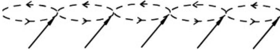
Figura 3.3: Ilustração de uma onda de spin com comprimento de onda infinito (modo uniforme). As ondas de spin são quantizadas, sendo seu quantum chamado mágnon. Os mágnons são excitados termicamente e obedecem à estatística de Bose-Einstein .
