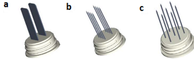
Figura 2.7: Eletrodos a) placas paralelas, b) agulhas em paralelo, c) agulhas em hexagonal. (Giardino et al., 2006).
