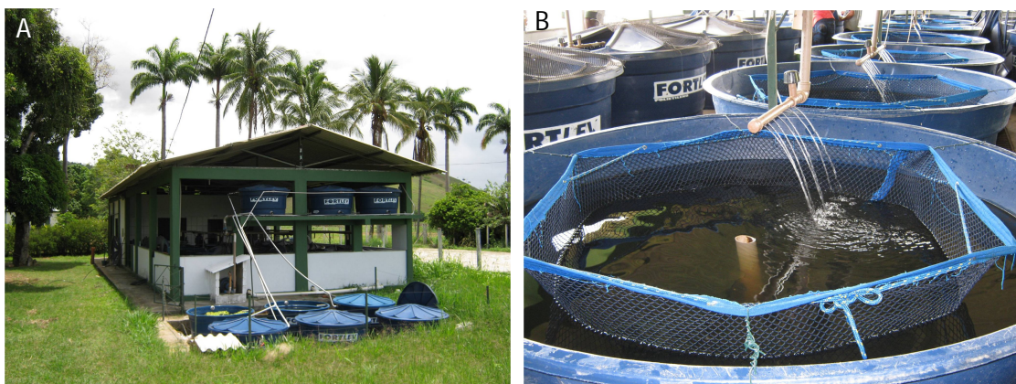
Figura 2. a) Laboratório de aquicultura em sistema de recirculação; b) Caixas adaptadas de fibra de vidro com volume total de 1.000 L, equipadas com sistemas de adução, drenagem de fundo e hapas para evitar com que os peixes tenham acesso aos resíduos fecais e biofilme no fundo e paredes da caixa.
