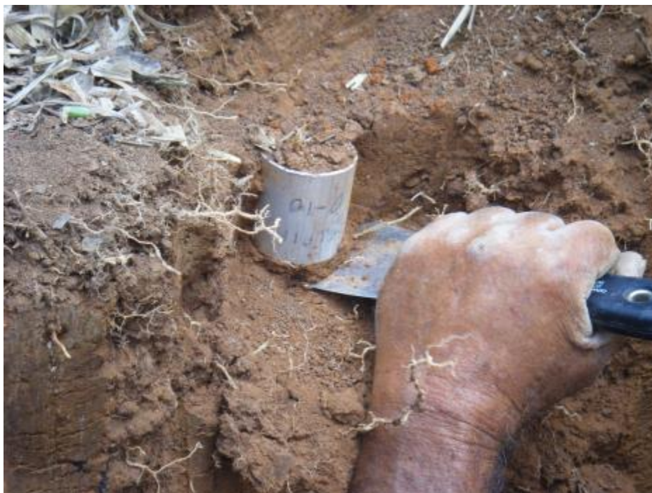
Figura 10: retirada do cilindro volumétrico (tipo Uhland) de amostras indeformadas para determinação da densidade do solo. Fazenda Campo Alegre, município de Itapecerica – MG, 2013. Fonte: arquivo pessoal
