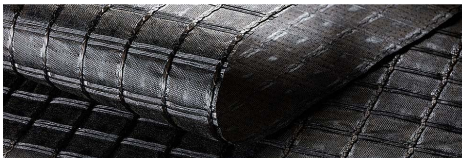
Figura 3.1 – Imagem da geogrelha utilizada nesta pesquisa (www.huesker.com.br, 2015).
