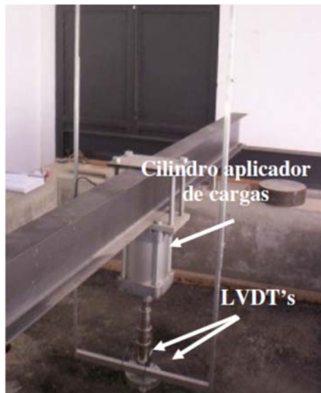
Figura 2.10 – Imagem da caixa teste utilizada para os ensaios em verdadeira grandeza (BASTOS, 2010).
