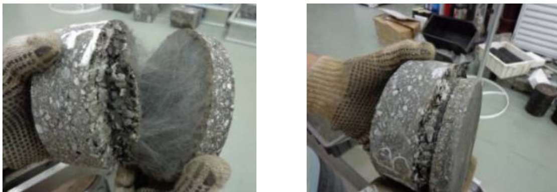
Figura 4.22 – Corpos de prova que romperam na mistura (GUIMARÃES, 2013).
