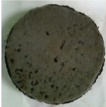
Figura 4.24 – Geotêxtil com impregnação de material betuminoso por penetração invertida em corpo de prova utilizado nesta pesquisa.
