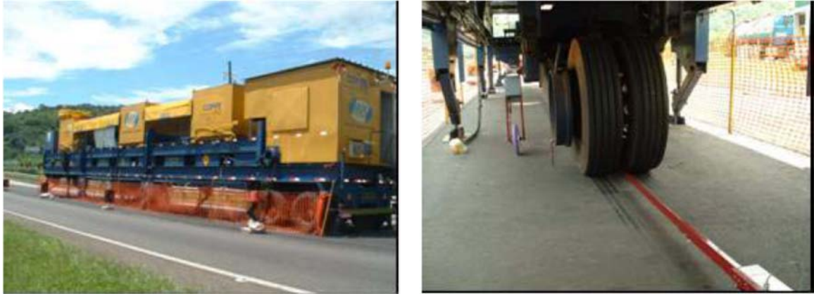
Figura 2.8 – Equipamento simulador de tráfego utilizado por Fritzen (2005).
