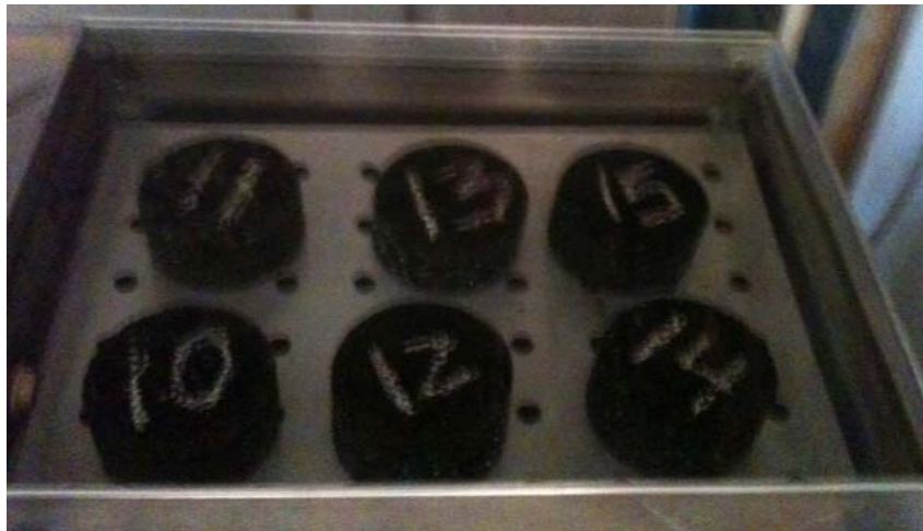
Figura 4.4 – Corpos de prova de mistura asfáltica em banho maria para preparação para ensaio de estabilidade.
