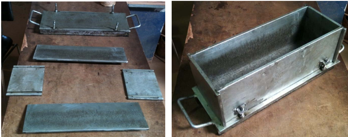
Figura C.1 - Molde de paredes rígidas, desmontável, metálico para moldagem dos corpos de prova.
