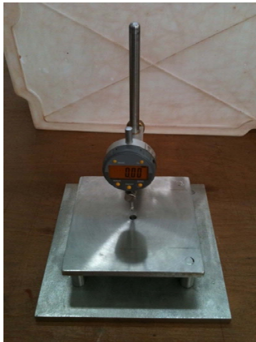
Figura 3.9 – Equipamento utilizado para determinação de espessuras (SANTOS, 2014).
