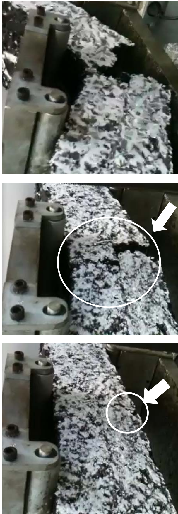
Figura 4.33 – Imagens do ensaio de tração na flexão no sistema geotêxtil: (a) início de formação da trinca; (b) momento intermediário do ensaio e (c) final de ensaio, desligamento da prensa.
