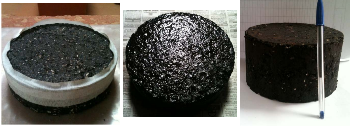
(a) base do CP preparada para a aplicação da pintura de ligação
