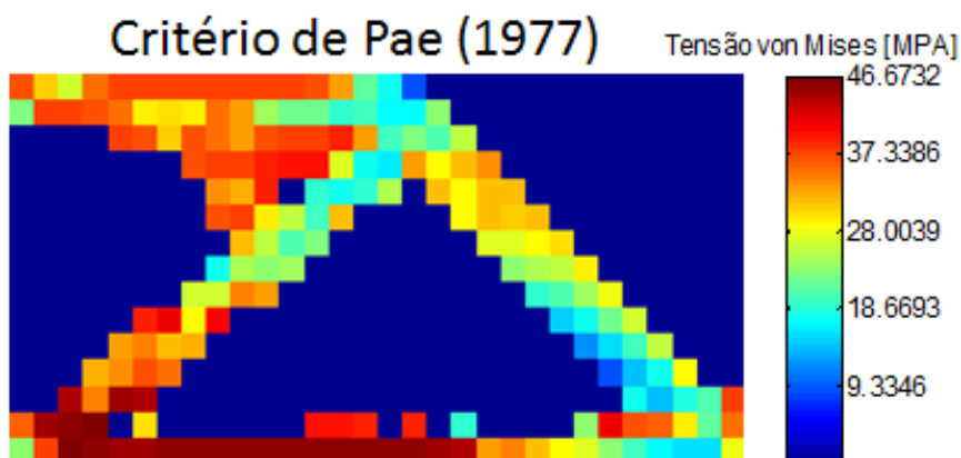
Figura 4.26 - Tensões de von Mises para o terceiro caso com o critério de Pae (1977) utilizando os parâmetros da Tabela 4.5.
