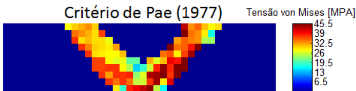
Figura 4.14 - Tensões de von Mises para a chapa em cisalhamento com o critério de Pae (1977) utilizando os dados da Tabela 4.5.
