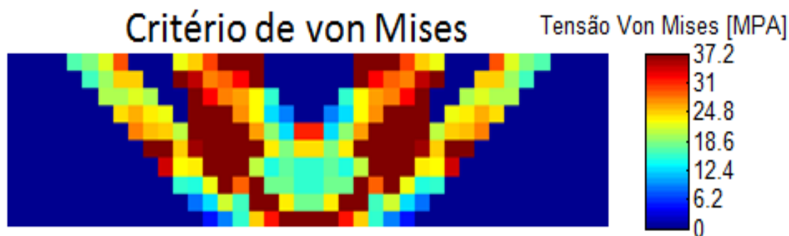
Figura 4.13 – Tensões de von Mises para a chapa em cisalhamento com o critério de von Mises utilizando os dados da Tabela 4.5.
