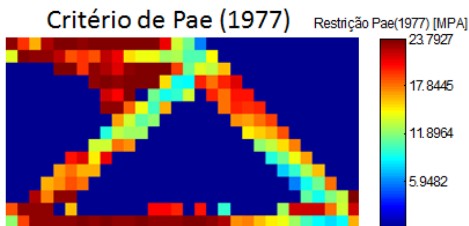
Figura 4.27 – Resultados da função de restrição com o critério de Pae (1977) para o terceiro caso.
