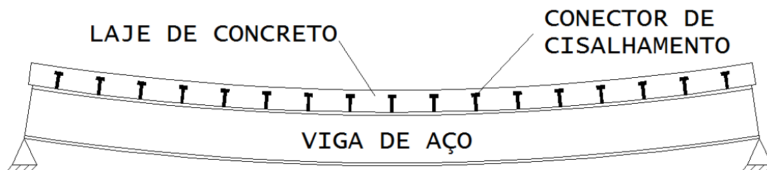
FIGURA 2.2 – Configuração deformada de uma viga mista simplesmente apoiada sob ação de cargas verticais. FONTE – Adaptado de QUEIROZ et al. (2001).
