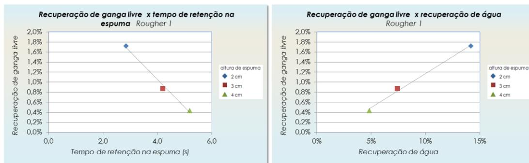
*Figura 5.6 – Recuperação de ganga livre em função do tempo de retenção na espuma e da recuperação de água*
