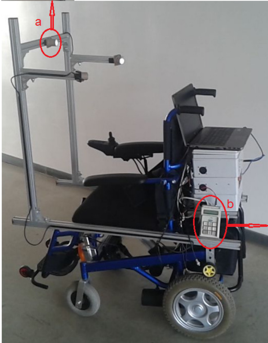
Figura 4.4 - Cadeira de rodas utilizada. a) Detalhe do LED utilizado na estimulação e b) sistema para configuração da estimulação visual.
