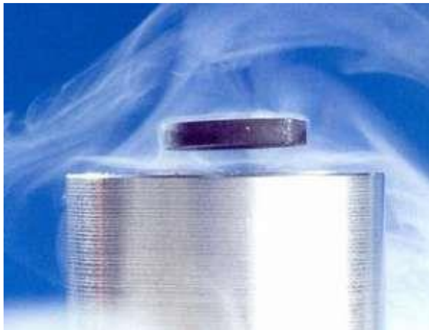
Figura 1- Demonstração da levitação de um supercondutor de Nióbio [4].
