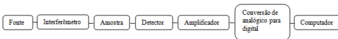
Figura 2: Componentes básicos de um espectrômetro FTIR. 43
