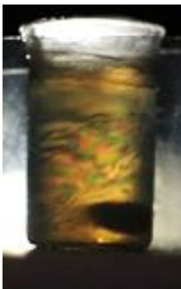
Figura 19. Birrefringência de uma suspensão de NCC à concentração de 4% m/v. Fotografia de uma dispersão obtida com os NCC utilizados neste trabalho.
