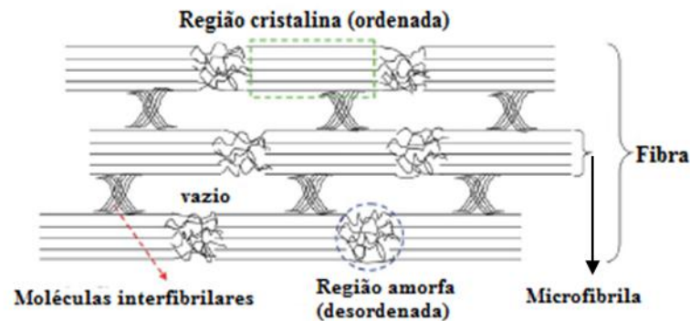
Figura 3. Esquema estrutural da microfibrila de celulose. Adaptado de Lin e colaboradores [2].
