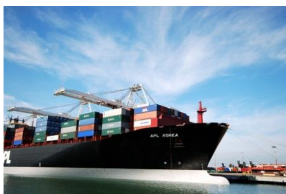
Figura 4.17 - Navio do tipo CON-RO para o transporte de automóveis e contêineres Fonte: Trans Global Auto Logistics (2015)
