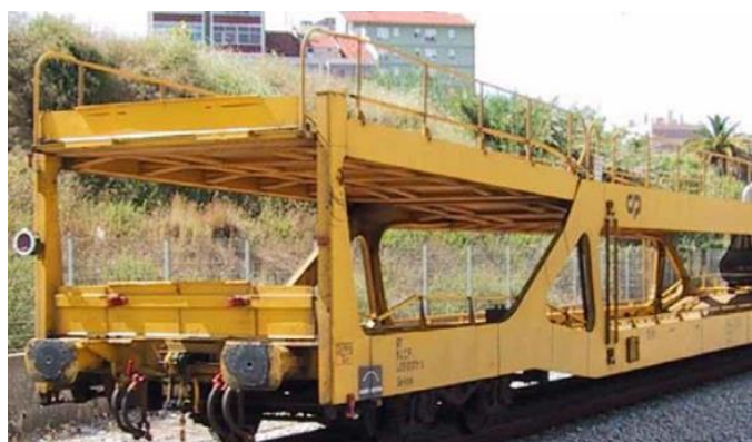
Figura 2.15 – Vagão plataforma de dois pavimentos para transporte de automóveis Fonte: CPCARGA (2011)
