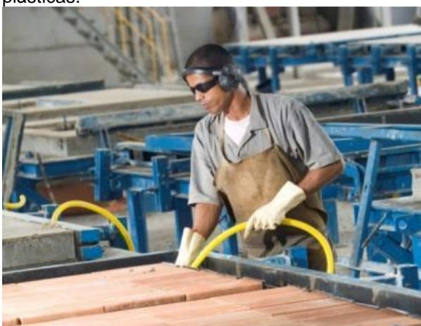
(e) Instalação dos eletrodutos, que posteriormente são conectados a caixa elétrica posicionada no painel.
