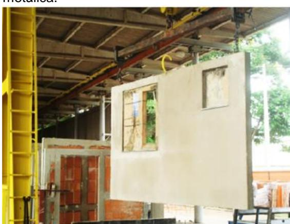
(j) Desenforma e transferência dos painéis à área de inspeção, por meio de pórtico rolante.
