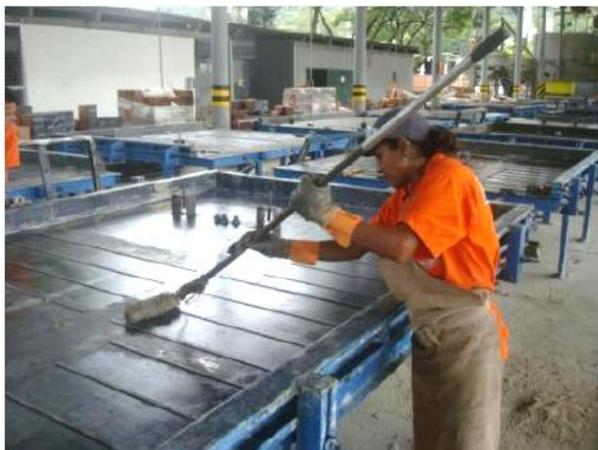
(a) Limpeza e aplicação de desmoldante nas fôrmas metálicas.
