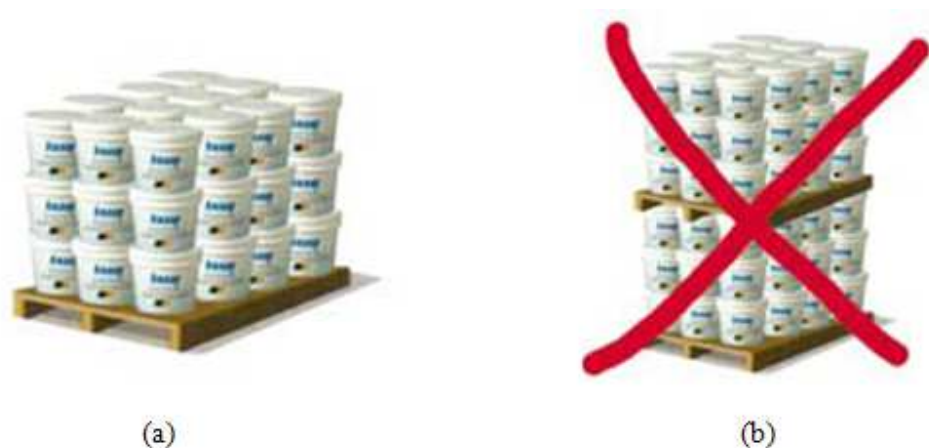
Figura 15 - Armazenamento dos baldes de massa, correto item (a), incorreta item (b). (KNAUF, 2009)
