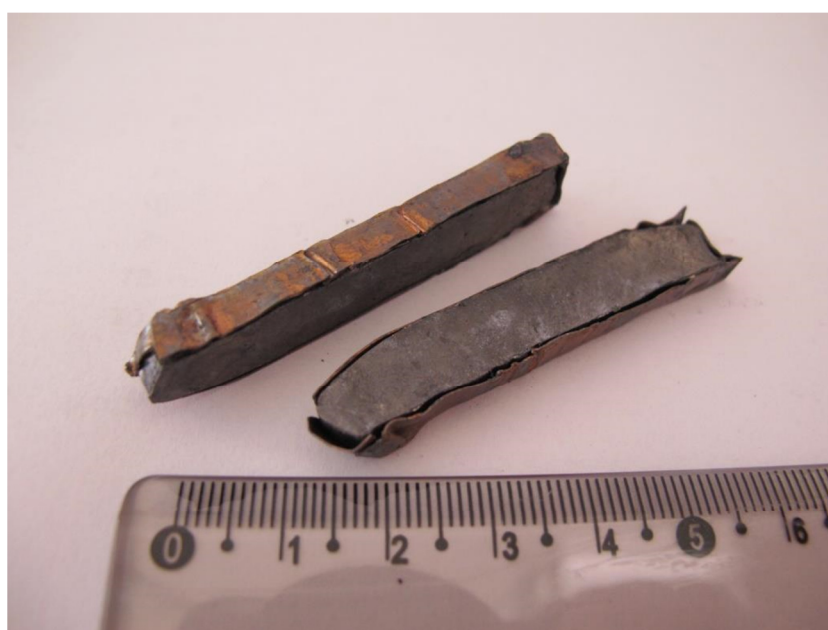
Figura 4.2 – Foto de um corpo de prova montado, com duas lâminas de magnésio de 4,7 mm de espessura cobertas com uma folha de cobre.
