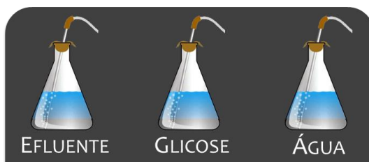
Figura 4.2 - Esquema da instalação experimental de degradação biológica aeróbia
