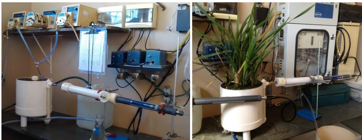
Figura 4.15: Testes hidrodinâmicos no reator de leito fixo não plantado (esquerda) e no reator de leito fixo plantado com *Typha* (direita).
