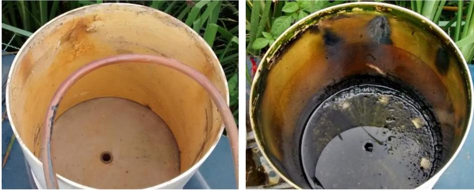
Figura 5.3: Interior do RLF plantado com *Canna* região central (esquerda) e do RLF não plantado região saída (direita) em 30/10/2014.
