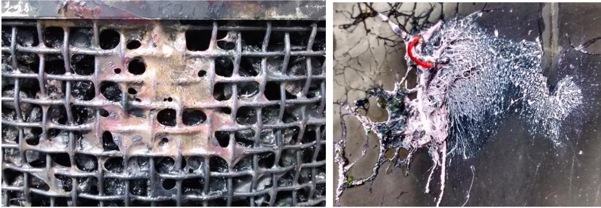
Figura 5.6: Biofilme da cesta do RLF não plantado região de saída (esquerda) e biofilme do interior do RLF não plantado região de saída (direita) em 07/01/2015.
