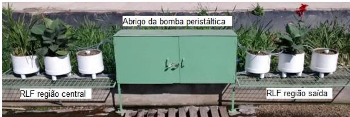
Figura 4.8: Aparato experimental dos reatores de leito fixo.
