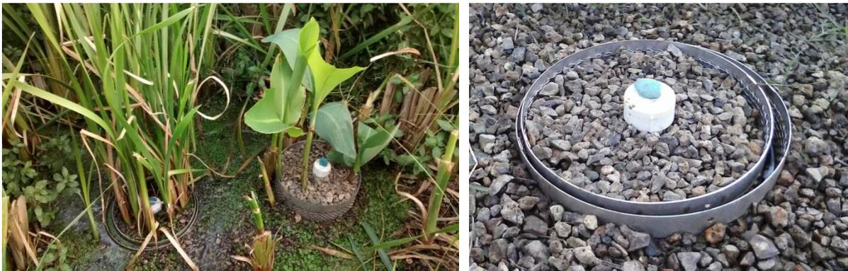
Figura 4.6: Cestas plantadas com *Typha latifolia* e *Canna x generalis* (esquerda) ambientando no leito do SAC plantado; e cesta não plantada (direita) ambientando no leito do SAC não plantado.
