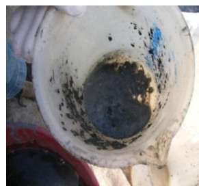
Figura 7.3 – Espuma acumulada no separador trifásico do reator R_{mod} . Pequena quantidade de material acumulado retido na peneira.
