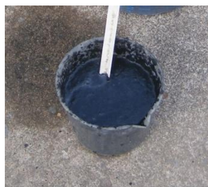
Figura 7.2 – Espuma acumulada no separador trifásico do reator R_{conv} . Grande quantidade de material coletado retido na peneira
