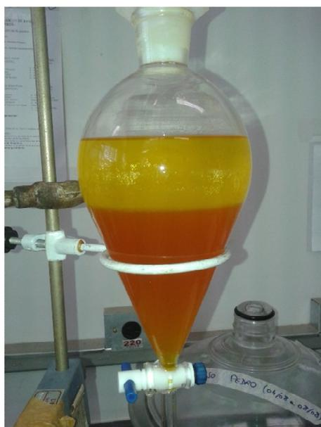
Figura 41: Separação de fases após a agitação nas etapas de extração líquido-líquido.
