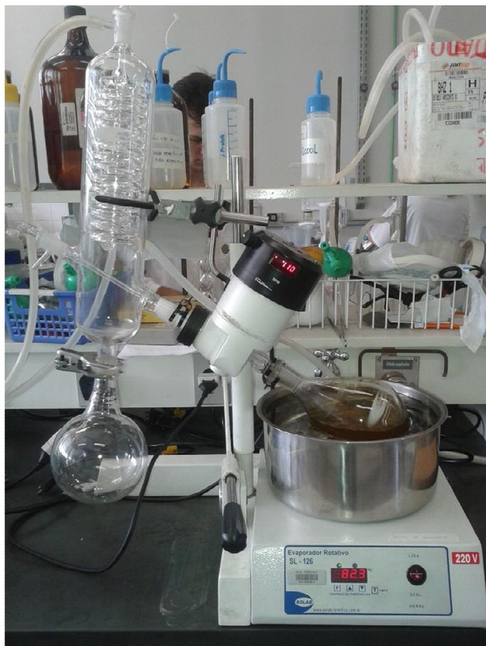
Figura 44: Rotavapor utilizado para a remoção do solvente no extrato e no produto da esterificação.
