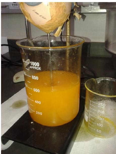
Figura 40: Mistura do óleo e do solvente nas etapas de extração líquido-líquido.
