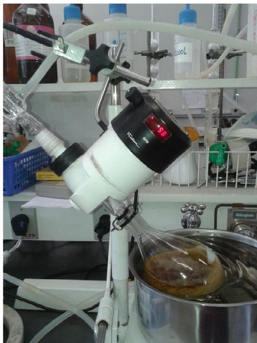
Figura 42: Reator rotativo utilizado na produção em bancada.
