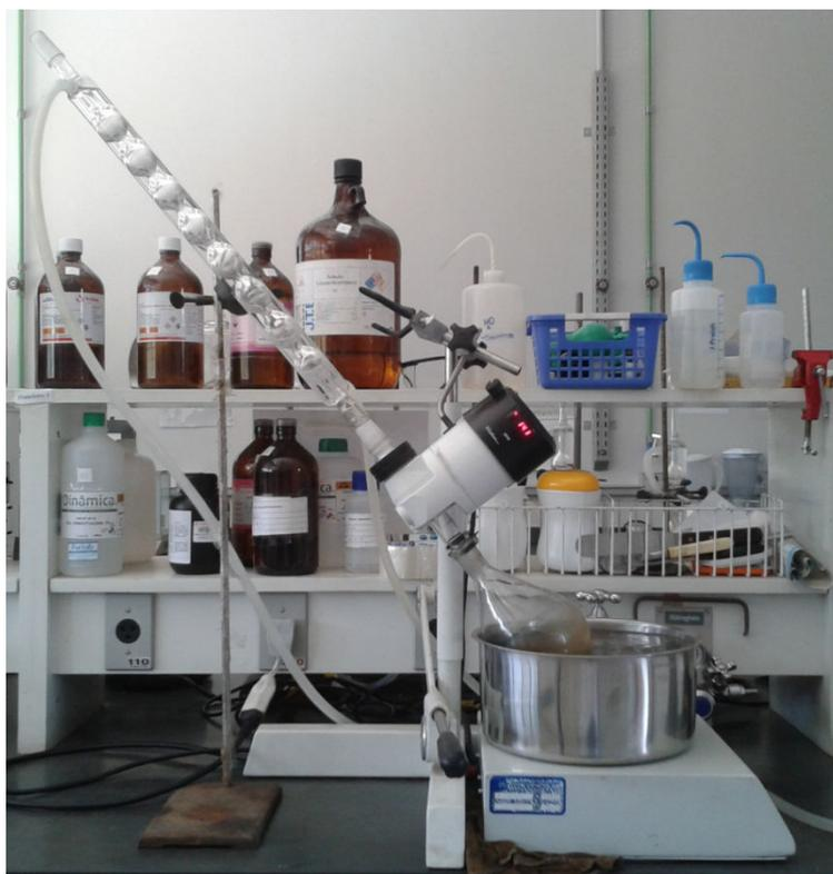
Figura 20: Reator utilizado nas reações de esterificação.
