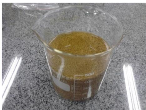
Figura 21: Tratamento inicial da resina para remoção de água residual.
