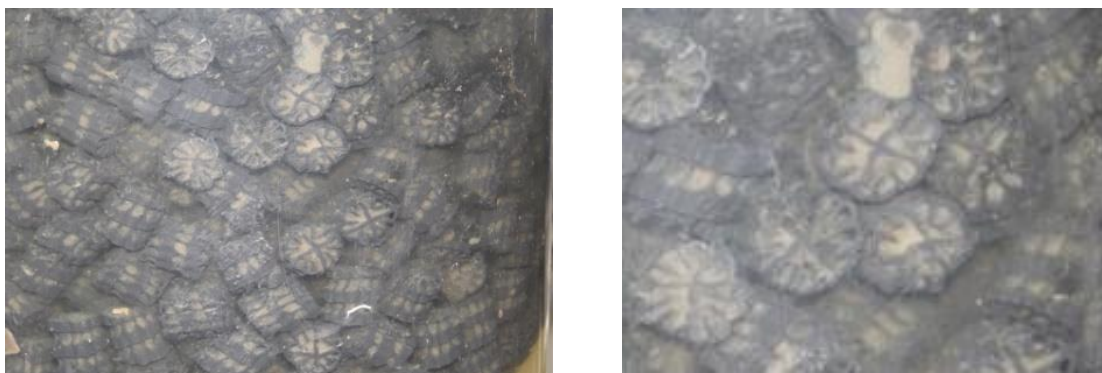
Figura 5.13 - Biomassa aderida ao meio suporte no sistema MBBR para tratar efluente do biodiesel
