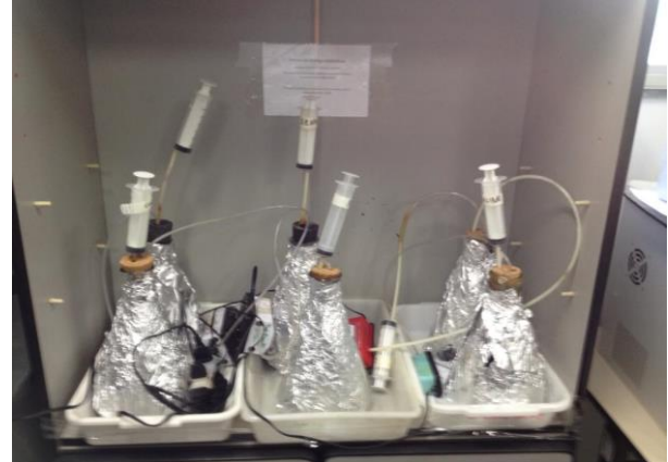
Figura 4.3 - Montagem final utilizada nos ensaios de biodegradabilidade aeróbia.
