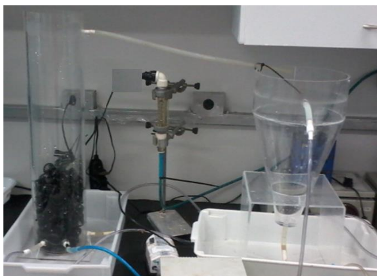
Figura 4.7 – Imagem do reator biológico com leito móvel e decantador sem operação
