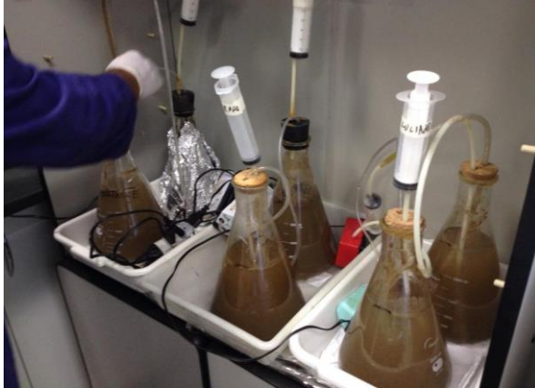
Figura 4.2 - Início da montagem utilizada nos ensaios de biodegradabilidade aeróbia.
