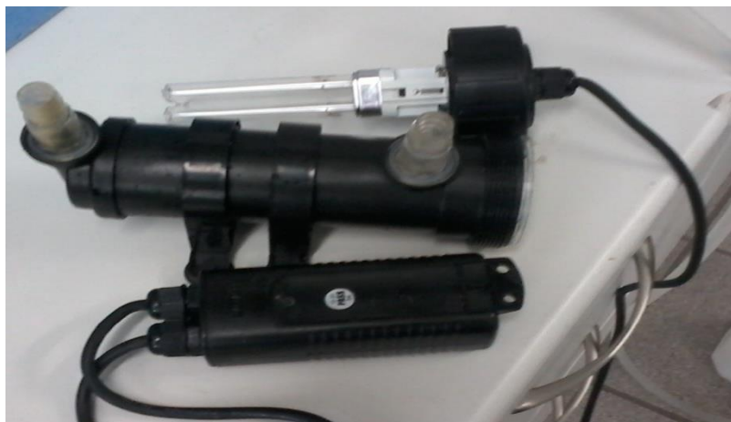
Figura 4.11 - Reator comercial utilizado nos experimentos de foto-Fenton (UV).
