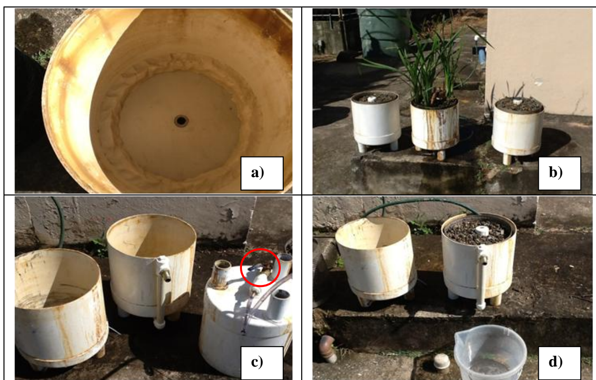
Figura 5.36. Aparato utilizado na medição de k_s : a) cesta externa sem saída lateral, contendo betume no fundo para impedir a passagem da água por fora da cesta interna; b) cestas encaixadas e conjunto pronto para a medição; c) detalhe das configurações distintas na montagem dos sistemas, torneira (em destaque na cesta colocada de cabeça para baixo); e d) detalhe da tubulação instalada para colocar a saída da água um pouco (3,7 cm) abaixo da altura de preenchimento com escória.
