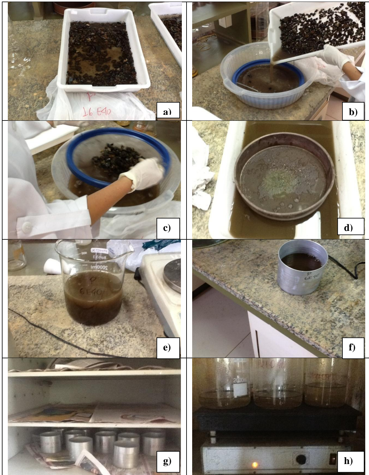
Figura 5.26. Passos para a lavagem e separação do material colmatante do substrato: (a) período de molho e atritamento; (b) peneiramento do líquido de lavagem; (c) peneiramento adicional; (d) separação no crivo que segrega os sólidos de colmatção; (e) líquido passado na peneira, deixado em repouso para decantação; (f) separação do sedimentado do decantado; (g) sedimentado segue para a estufa; e (h) decantado segue para aquecimento e evaporação.
