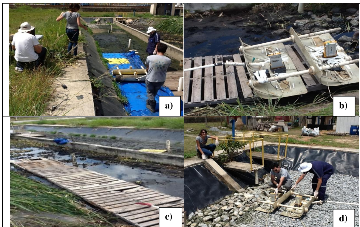
Figura 5.19. Perfil longitudinal no SAC C (lona plástica requerida) (a), no SAC P (estrado de madeira) (b, c) e no FG (sem necessidade de cobrimento do leito) (d).
