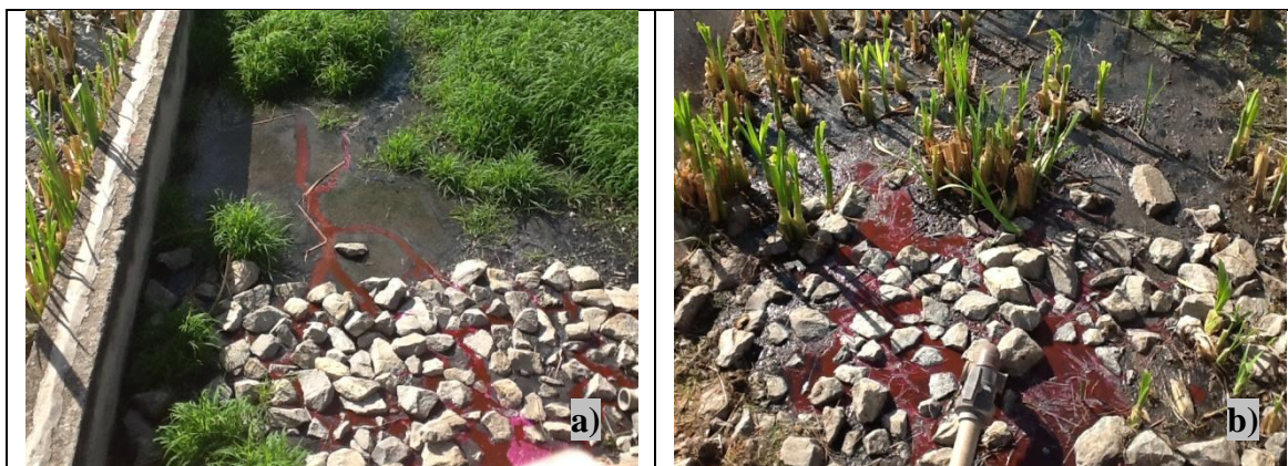
Figura 6.16. Visualização do escoamento superficial nos SAC C (a) e SAC P (b) possibilitado pelo uso da rodamina.
