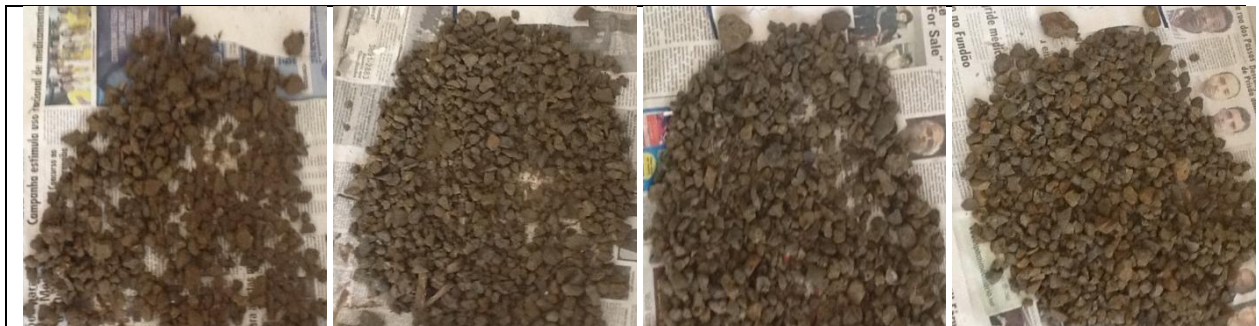
Figura 6.28. Amostras de sólidos acumulados nos poros misturados ao substrato, coletados a 21,0 m de distância da entrada, no SAC P, nas camadas de 0-15 (a) e 15-40 cm (b), e no SAC C, nas camadas de 0-15 (c) e 15-40 cm (d).
