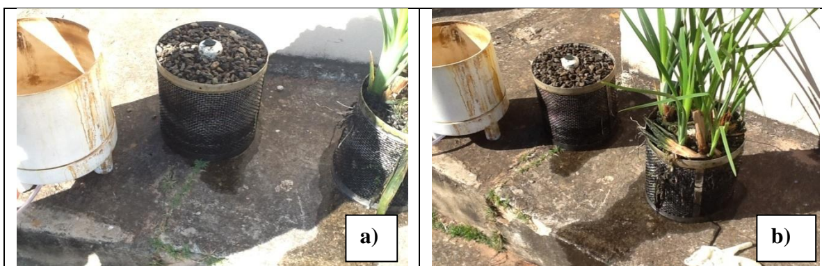
Figura 5.35. Imagens das cestas do PFR , utilizadas nos testes de medição da condutividade hidráulica, retirados de poços localizados a 13,0 m da entrada do: a) SAC C e b) SAC P.
