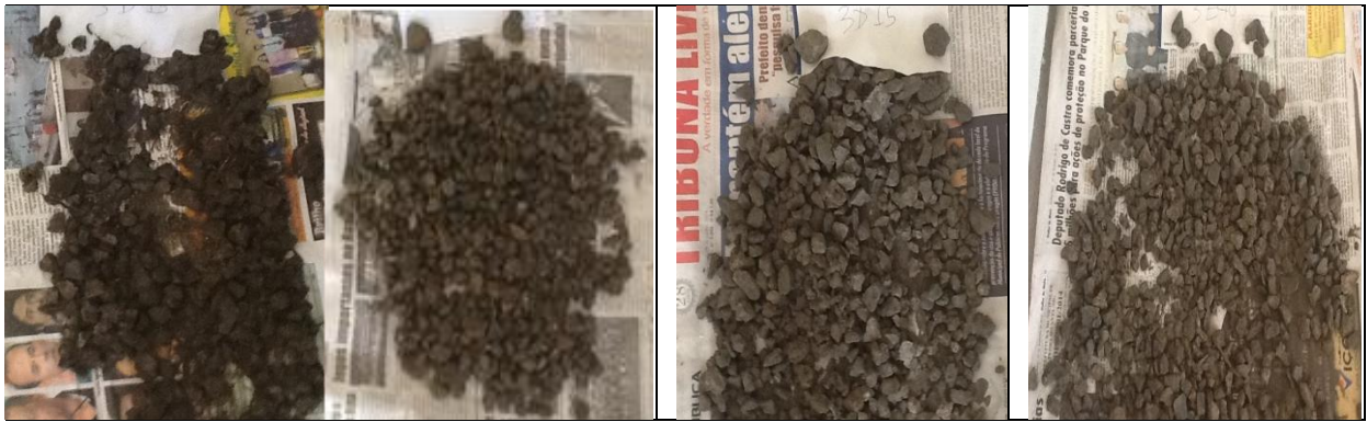
Figura 6.25. Amostras de sólidos acumulados nos poros misturados ao substrato, coletados a 3,0 m de distância da entrada, no SAC P, nas camadas de 0-15 cm (a) e 15-40 cm (b), e no SAC C, nas camadas de 0-15 (c) e 15-40 cm (d).
