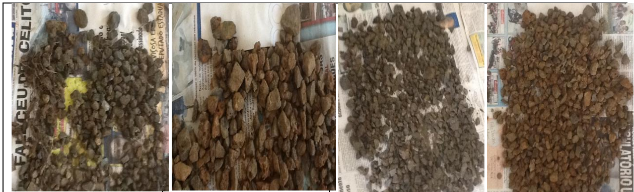
Figura 6.27. Amostras de sólidos acumulados nos poros misturados ao substrato, coletados a 16,0 m de distância da entrada, no SAC P, nas camadas de 0-15 (a) e 15-40 cm (b), e no SAC C, nas camadas de 0-15 (c) e 15-40 cm (d).
