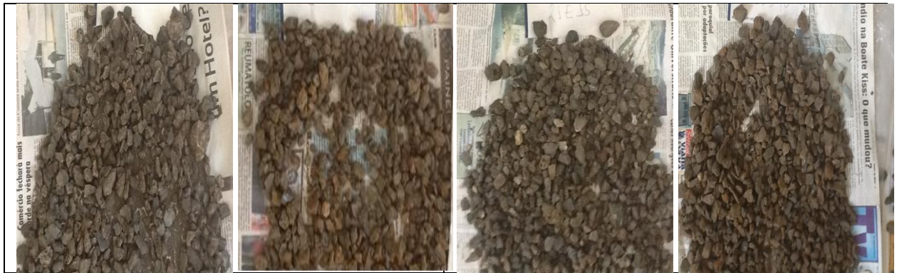
Figura 6.26. Amostras de sólidos acumulados nos poros misturados ao substrato, coletados a 11,0 m de distância da entrada, no SAC P, na camada de 0-15 (a) e 15-40 cm (b), e no SAC C, nas camadas de 0-15 (c) e 15-40 cm (d).
