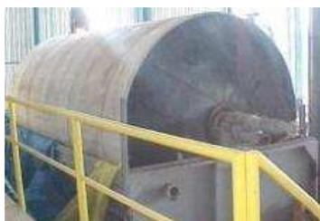
**Figura 3:** Filtro a vácuo tipo disco
