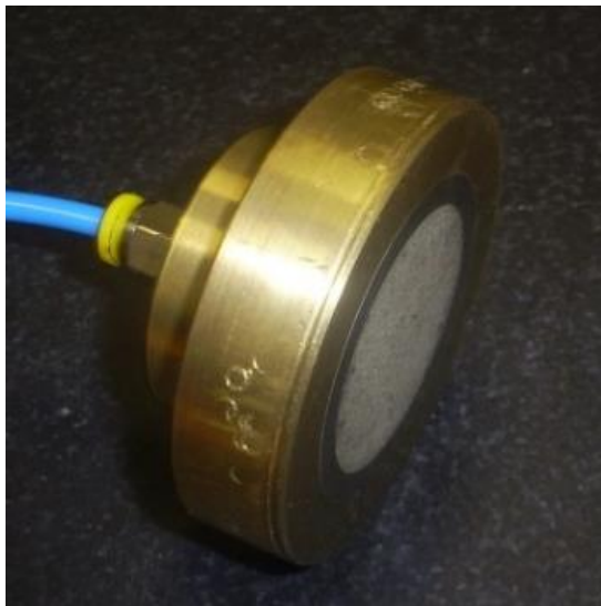
Figura 4.15 – Unidade de mancal aerostático axial com restritor cimentício.
