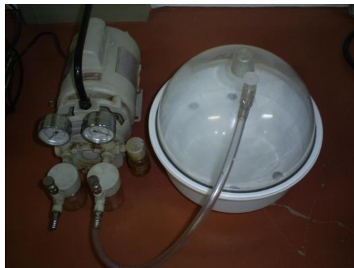
Figura 4.6 - Câmara de vácuo para ensaio de porosidade aparente.
