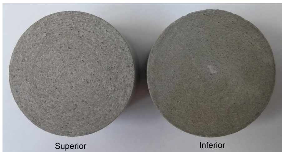
Figura 5.19 - Seções transversais superior e inferior para as pastas fabricada com 0,05% de NTC e 1,0% de SP.
