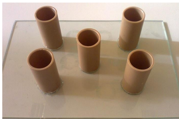
Figura 4.4 – Moldes poliméricos para o processo de compactação por vibração.
