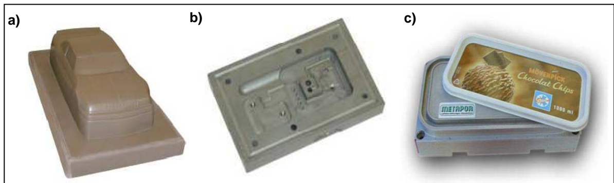
FIGURA 2.19 - Exemplos de materiais aplicados a moldes para termoformagem: a) Molde em resina epóxi fundido BC7136 ; b) Molde em uretano fundido BC8010 e; c) Molde em compósito METAPOR HD 210 AL.
