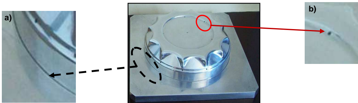
FIGURA 2.20 - Exemplo de orifícios para sucção de ar entre molde e folha; a) Canal; b) Furo.
