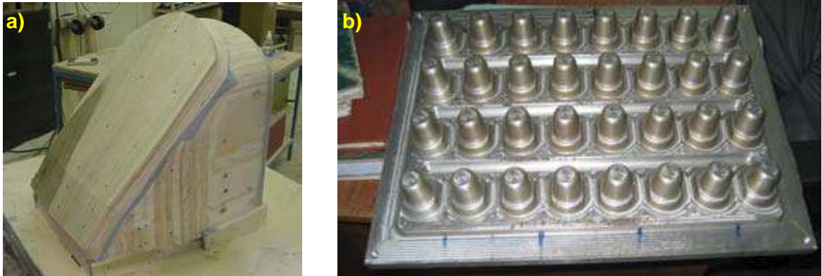
FIGURA 2.18 - Exemplos de aplicação de moldes para termoformagem: a) Molde em madeira do protetor de roda de um veículo; b) Molde para copos descartáveis.
