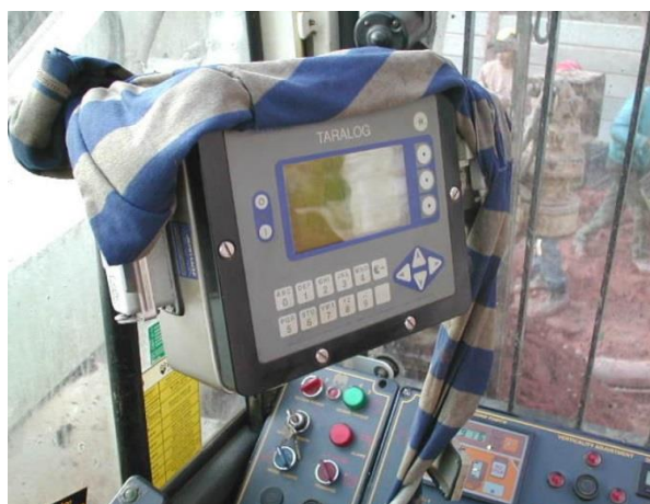
Figura 28 – Equipamento utilizado no monitoramento durante a execução da estaca hélice contínua Fonte: Notas de aula disciplina TEC I, UFMG, 2008.
