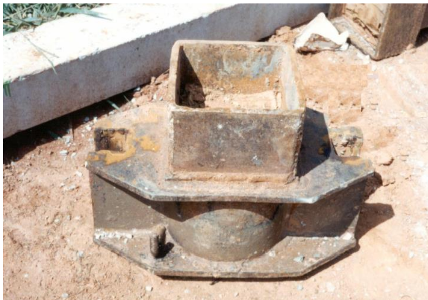
Figura 20 – Imagem de um capacete metálico utilizado na proteção da cabeça das estacas Fonte: Notas de aula disciplina TEC I, UFMG, 2008.
