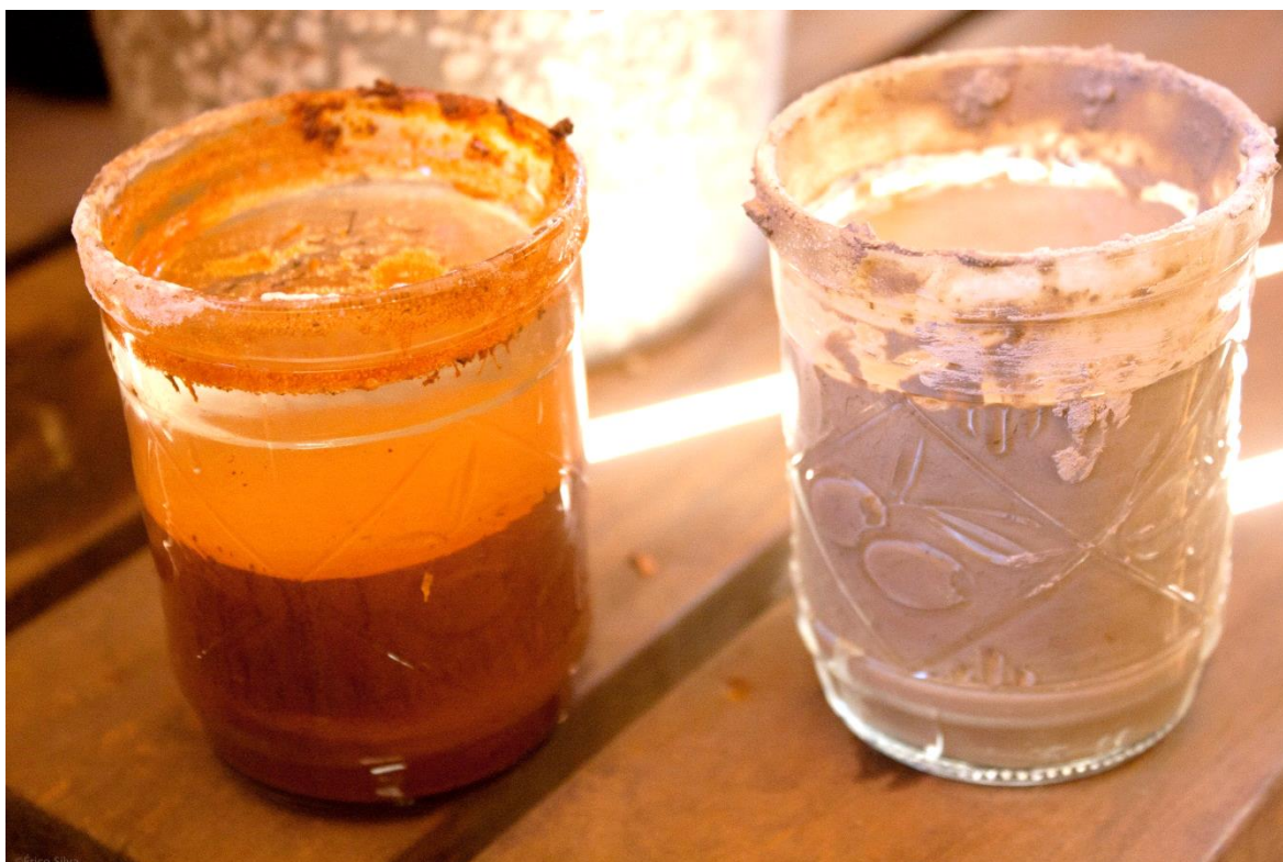
Figura 16- Amostra de solos argilosos locais. Destaque para argila branca (à direita) utilizada no preparo da tabatinga.
