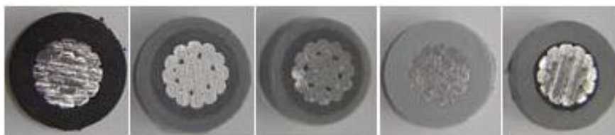
Figura 2.12 - Cabos cobertos com XLPE produzidos no Brasil [adaptado de (NÓBREGA et al., 2012)].
