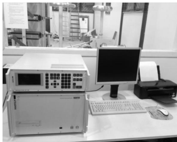
(d) Sistema de medição e controle
