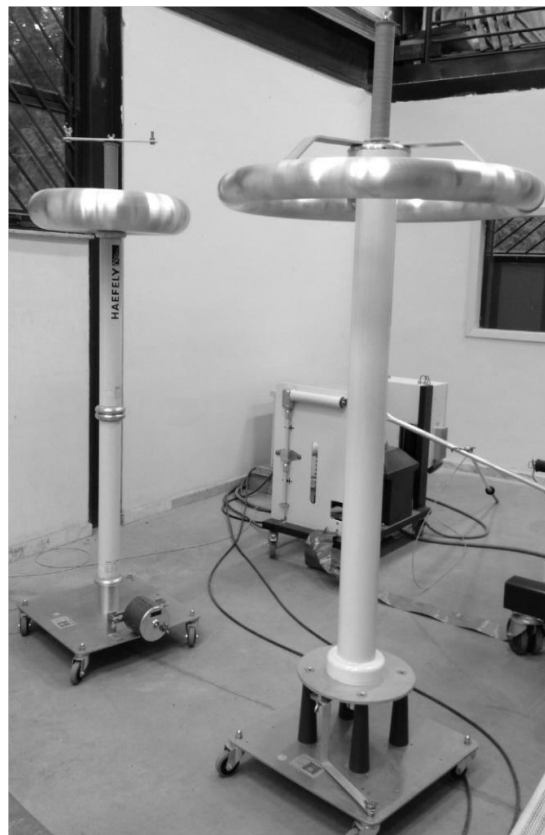
(b) Divisor capacitivo (dir.) e resistivo (esq.)
