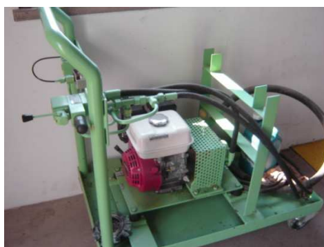
Figura 3.49 - Motobomba de emergência.
