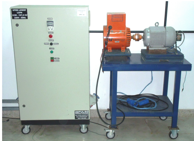
Figura 2.10: Vista do gerador síncrono de excitação independente e do simulador de turbina utilizados nos testes experimentais.
