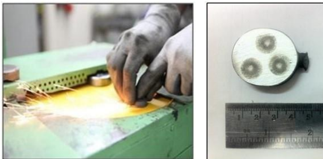
Figura 4.8 – Preparação da amostra para análise da composição química no espectrômetro de emissão ótica (MURTA, 2013)
