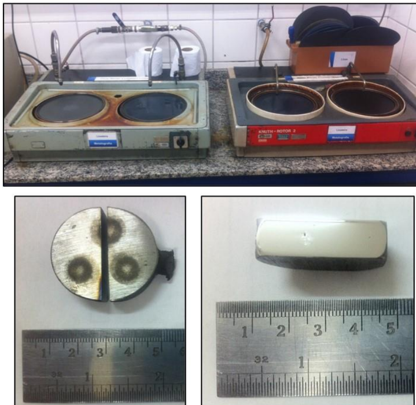
Figura 4.10 – Preparação da amostra com polimento para análise de inclusão no MEV.
