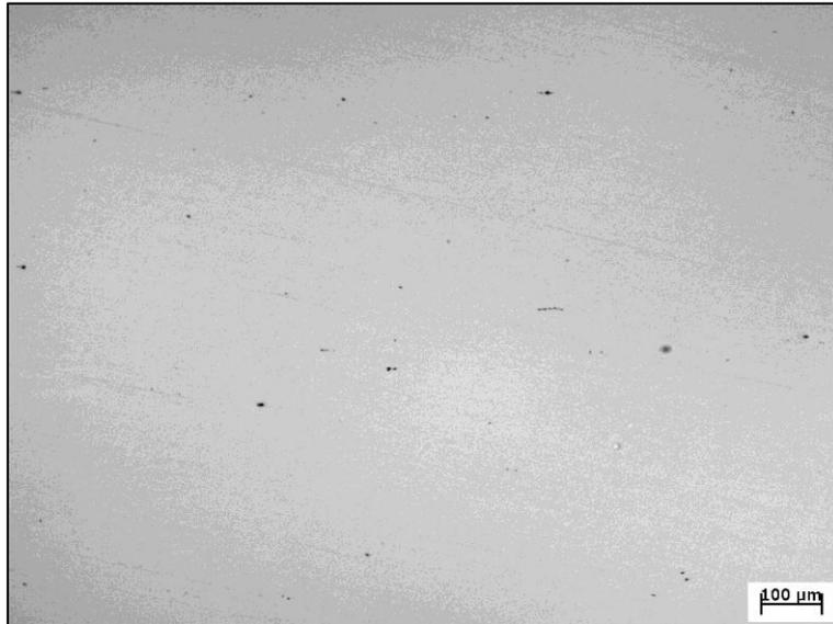
Figura 5.1 – Campo representativo das inclusões na amostra de DP800. Ampliação original: 100X. Sem ataque.
