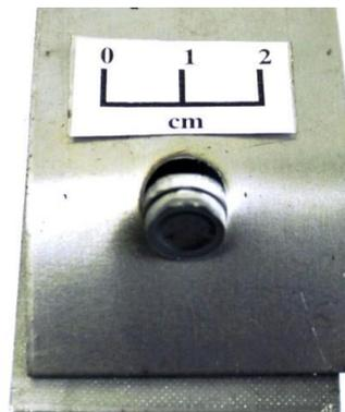
(c) Fratura em botão no metal base ocorrida para correntes próximas ao  $I_{\max}$  em juntas soldadas realizadas com tempo de soldagem de 9/2/9/2/9 ciclos.
