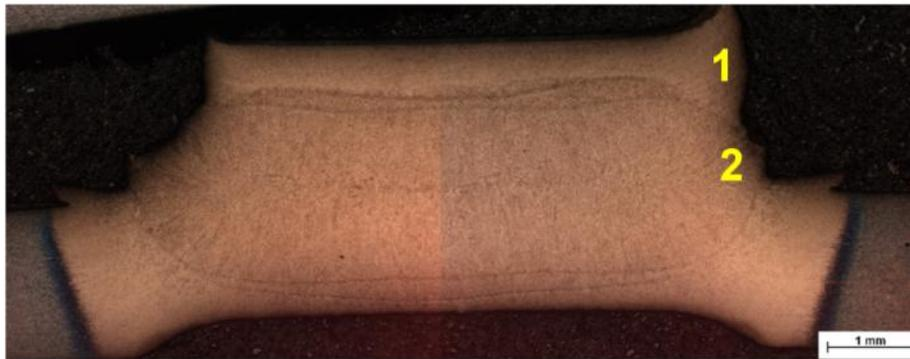
Figura 5.43 – Representação da seção trasversal de uma fratura em botão adquirida após ensaio de tração cruzada, em uma junta soldada de 22MnB5/DP800. Parâmetros de soldagem: condição P2, força aplicada pelos eletrodos: 5 kN; tempo de soldagem: 9/2/9/2/9 ciclos, corrente: 8,80 kA.
