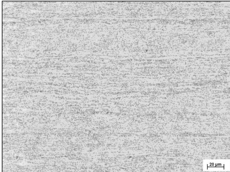
Figura 5.4 – Aspecto da microestrutura da amostra de aço 22MnB5 “como recebido”. Ampliação original: 500X. Ataque: nital 2%.
